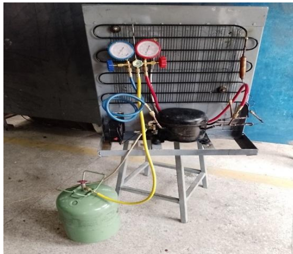
Fig. 1. Vapour compression refrigeration test rig.
